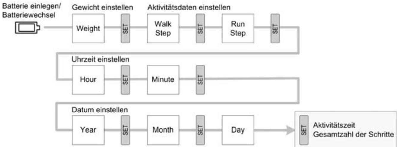
Werte einstellen mit **MENU**. Kurzes Drücken = Einzelwerte, langes Drücken = durchlaufend.
